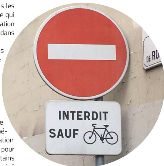
*Le double sens cyclable est signalé par le panneau « sauf vélos » (M9v2), en complément du panneau « sens interdit » (B1) en entrée de site. Les automobilistes peuvent être avertis par panneaux (C24a ou c).*
