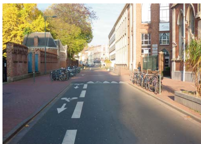
Rue du port : marquage séparatif de type bande cyclable
