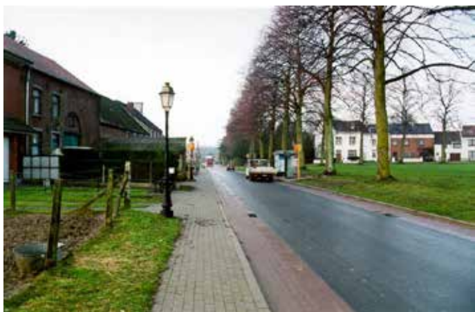
Figure 1.3. Cette bande cyclable suggérée est réalisée en pavés de béton. Elle réduit visuellement la largeur de la chaussée et incite les véhicules à circuler au centre, sans que cela ne soit une obligation. Il est cependant préférable d'éviter de placer l'avaloir sur la trajectoire des roues, tant des automobilistes que des cyclistes.
