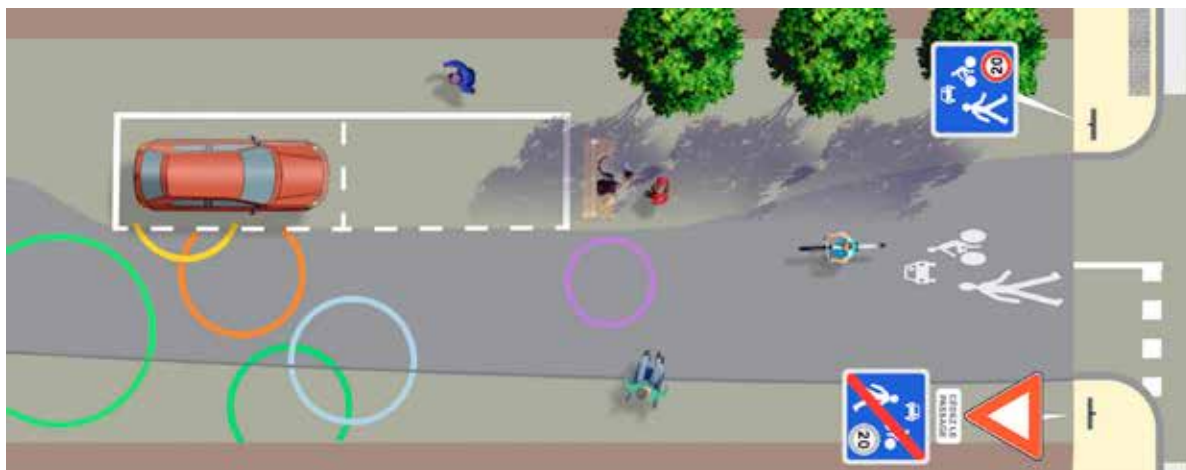
Signalisation d'entrée de zone de rencontre complétée par du marquage. Le régime de priorité en sortie de la zone de rencontre est à adapter à la situation rencontrée (type d'axe, visibilité, vitesse pratiquée, volume et type de trafic). Le choix du cédez-le-passage n'est pas une règle générale mais une facilité de représentation.
