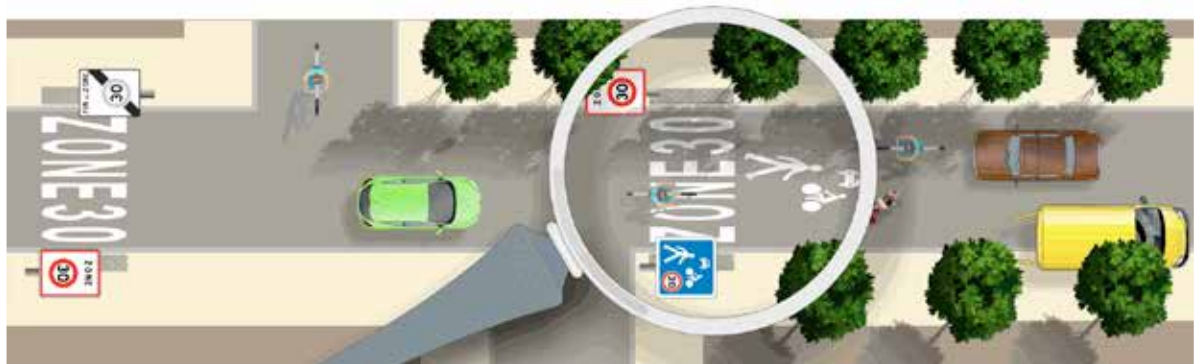
Signalisation de transition zone 30 - zone de rencontre, complétée par du marquage pour les deux zones
